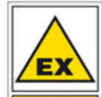
ZONA CON RIESGOS DE ATMÓSFERAS EXPLOSIVAS
